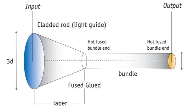
LightGuideOptics' aufgeschmolzene Fasertapers sind für hohe Leistungsübertragung entwickelt. Durch die vergrößerte Oberfläche ist die Einkopplung einfacher und das Risiko reduziert.
